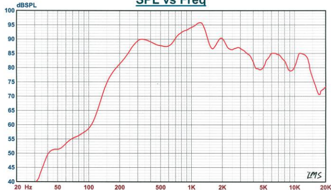
Curva de sensibilidade x frequência 1W/1m SPL vs Freq
